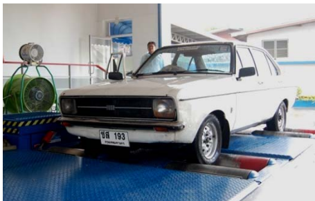
รูปที่ 5 การทดสอบรถยนต์บนแท่นทดสอบ
