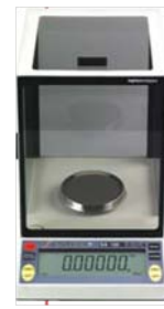
รูปที่ 3 เครื่องชั่งดิจิตอล (ScienTech Model 210D)
