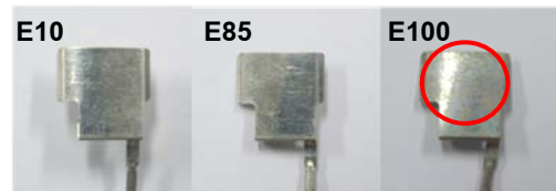
รูปที่ 8 แสดงการกัดกร่อน ของ Wire comp Vehicle B
