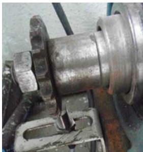
รูปที่ 12 แสดงการยึด proximity sensor และเฟืองโซ่ของรถจักรยานยนต์เพื่อใช้วัดความเร็วรอบ
