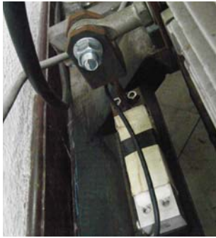
รูปที่ 11 แสดงการยึดโหลดเซลล์กับแกนของแควร์มอเตอร์
