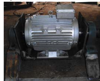
รูปที่ 9 แสดงแท่นเปลของมอเตอร์เพื่อให้มอเตอร์หมุนได้อิสระ
