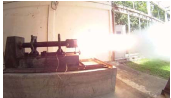
รูปที่ 5 การทดสอบภาคสถิติจรวดขนาดเล็ก
