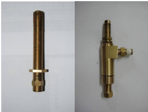
รูปที่ 1 แสดงลักษณะ ก.) หัวฉีดที่ยังไม่ได้รับการพัฒนา และ ข.) หัวฉีดที่ได้รับการพัฒนาแล้ว
