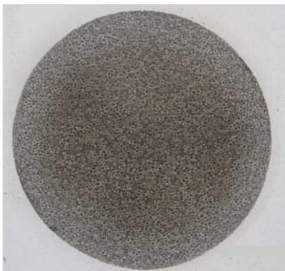
รูปที่ 1 วัสดุพอร์ซชนิดโลหะเซลลูลาร์เปิดที่ทำมาจากนิเกิล-โครม (Ni-Cr)
