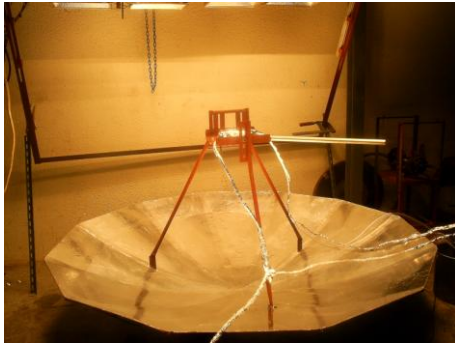
รูปที่ 3 ภาพถ่ายแสดงการทดสอบหาค่าความชื้นของรังสีอาทิตย์จำลองจากเครื่องจำลองรังสีอาทิตย์ และจานพาราโบลา
