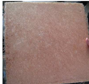
รูปที่ 2. ฟีนอลิกคอมโพสิตที่ขึ้นรูปลามิเนต
