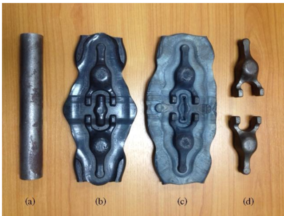
รูปที่ 1 (a) ชิ้นงานเพลากลม (b) ชิ้นงานที่ผ่านการทาบขึ้นรูปเตรียมชิ้นงานด้วยแม่พิมพ์ Blocker (c) ชิ้นงานที่ผ่านการทาบขึ้นรูปสำเร็จ (d) ชิ้นงานที่ผ่านการตัดครีบ
