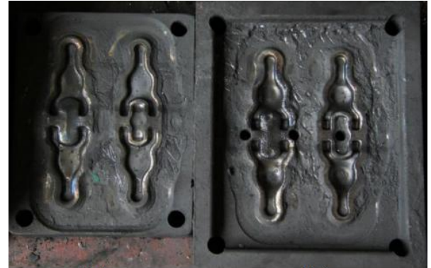
รูปที่ 2 แสดงแม่พิมพ์ Blocker ที่ผ่านการใช้งานไปแล้ว 10,000 ครั้ง (a) แม่พิมพ์ด้านบน (b) แม่พิมพ์ด้านล่าง
