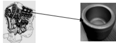
รูปที่ 2 แสดงชิ้นงานล้อสายพานเพลาลูกเบี้ยวที่อยู่ ในเครื่องยนต์
