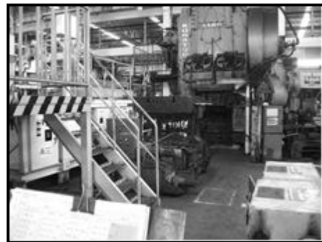
รูปที่ 7 Mechanical Press ขนาด 2500 Ton
