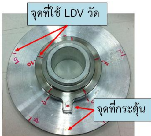
รูปที่ 8 แสดงจุดวัดต่างๆในการทดสอบหาค่า Coupling loss factor
