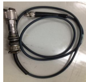
รูปที่ 5 อุปกรณ์ตัววัดความเร่ง รุ่น A0760GP
