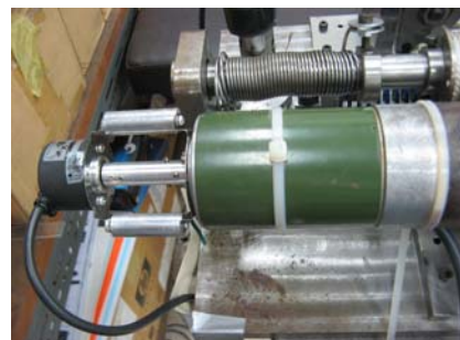
รูปที่ 12 เอ็นโคดเดอร์วัดตำแหน่งของมอเตอร์
