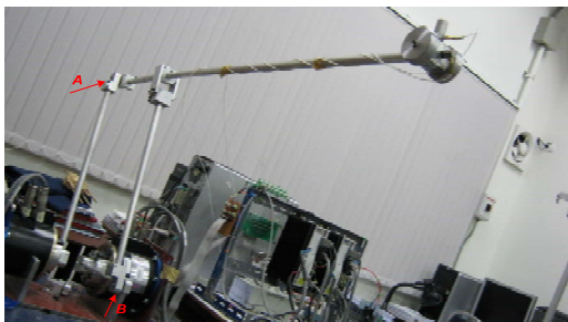
รูปที่ 3 แสดงตำแหน่งและทิศทางการเคาะระบบโครงสร้างแขนกล
