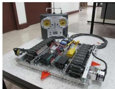
รูปที่ 1 ลักษณะของหุ่นยนต์ล้อตีนตะขาบและอุปกรณ์ส่งสัญญาณวิทยุ
