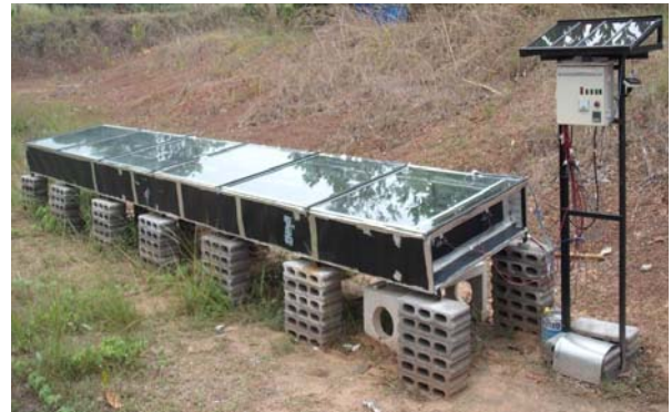
รูปที่ 2 ตู้อบแห้งผิวเมล็ดมะพร้าวพลังงานแสงอาทิตย์แบบอุโมงค์ลม
