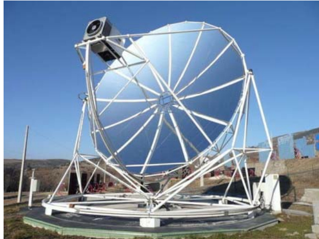
รูปที่ 2 งานรับพลังงานแสงอาทิตย์พาราโบลาและเครื่องยนต์สเตอร์ริง ที่มาURL: http://solar.web.psi.ch/data/facilities/
