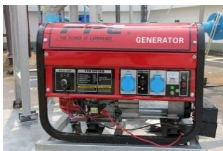
รูปที่ 2 เครื่องกำเนิดไฟฟ้า
