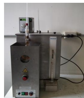
รูปที่ 5 ทดสอบวัดค่าอุณหภูมิการกลั่น
