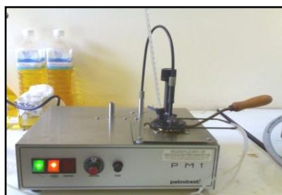
รูปที่ 1 ทดสอบวัดจุดวาบไฟโดยใช้เครื่องมือ Pensky-Martens
