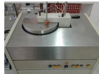
รูปที่ 4 ทดสอบวัดค่าความร้อนเชื้อเพลิง
