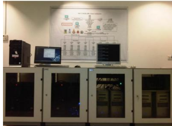
รูปที่ 2 ระบบคลัสเตอร์คอมพิวเตอร์สมรรถนะสูง
