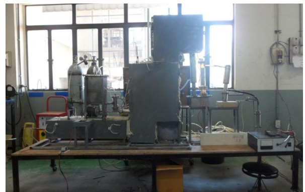
รูปที่ 1 หน่วยผลิตไฟโรไลซิสแบบเร็วของผักตบชวา
