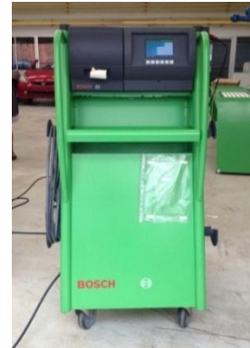
รูปที่ 3 เครื่องมือวิเคราะห์ก๊าซไอเสียรถยนต์ (BEA 350 - EU)
