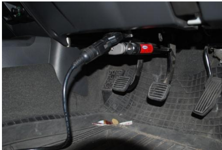
รูปที่ 6 อุปกรณ์ตรวจจับวัดความเร็วรอบเครื่องยนต์ TECH 2 (Data link connector)
