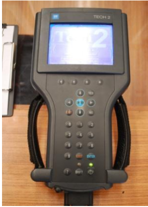
รูปที่ 5 อุปกรณ์ตรวจจับวัดความเร็วรอบเครื่องยนต์ TECH 2 (Data link connector)
