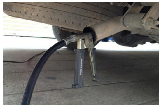
รูปที่ 4 อุปกรณ์การวัดก๊าซไอเสียใช้เครื่องมือวิเคราะห์ก๊าซไอเสียรถยนต์ (BEA 350 - EU)
