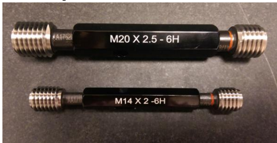
รูปที่ 4 เกลียววัดเกลียวที่ใช้ในการวิจัย
