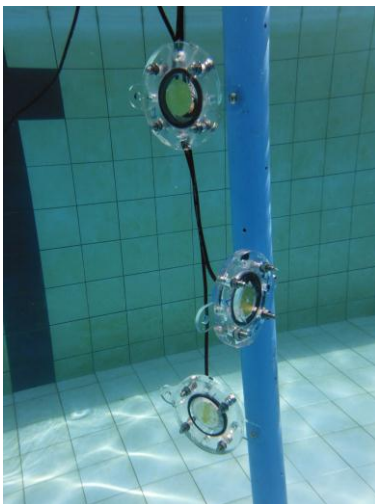
รูปที่ 4 การติดตั้งไฮโดรโฟนเพื่อทดสอบในสระว่ายน้ำ
