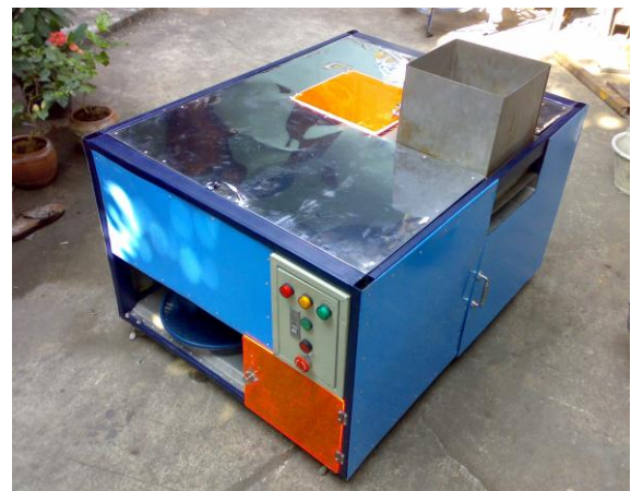
รูปที่ 1 ลักษณะของเครื่องแกะเมล็ดบัวเดิมก่อนการพัฒนา
