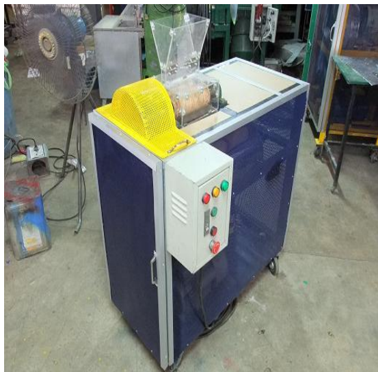
รูปที่ 11 เครื่องแกะเมล็ดบัวที่ได้ทำการออกแบบและพัฒนาใหม่เมื่อประกอบเสร็จสมบูรณ์
