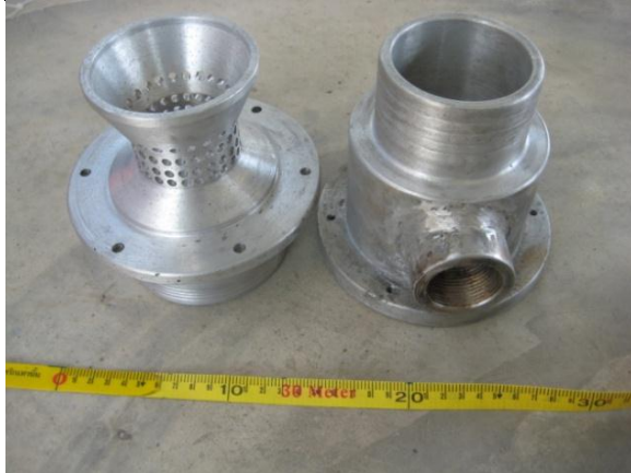
รูปที่ 3 Venturi mixer ที่ติดตั้งเข้ากับเครื่องยนต์
