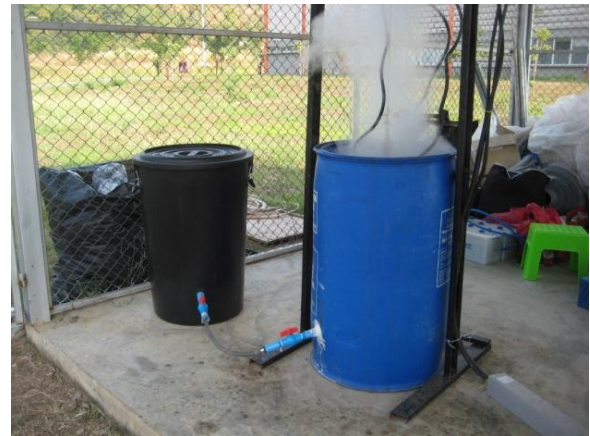
รูปที่ 5 ภาระทางไฟฟ้าเทียมที่ใช้ทดสอบ
