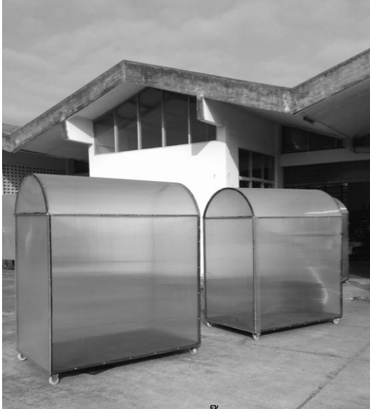
รูปที่ 1 ระบบอบแห้งแบบป้มความร้อนร่วมเรือนกระจก เทียบกับเรือนกระจกทั่วไป
