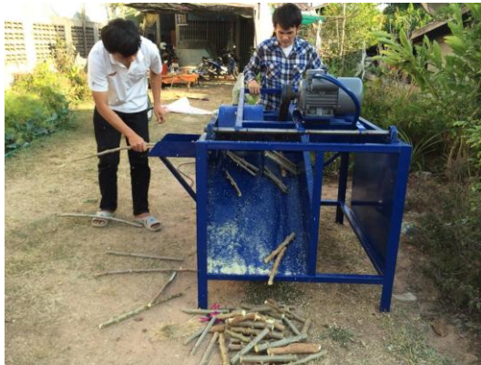
รูปที่ 3 การทดสอบเครื่องตัดท่อน้ำมันสำหรับหลัง
