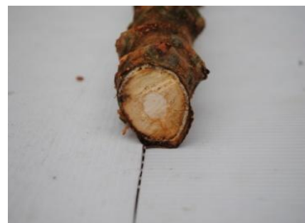
รูปที่ 5 ลักษณะผิวของการตัดที่ความเร็วรอบ 1,450 รอบ/นาที
