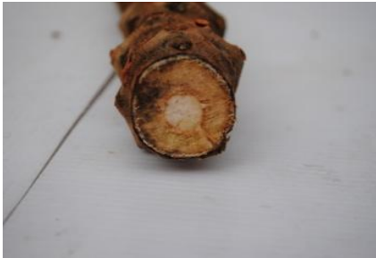
รูปที่ 6 ลักษณะผิวของการตัดที่ ความเร็วรอบ 1,900 รอบ/นาที
