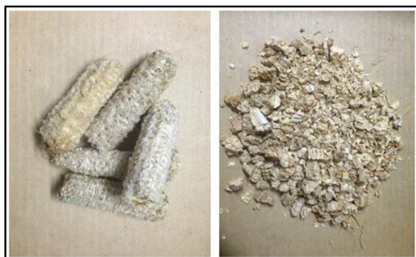
รูปที่ 2 ลักษณะของขังข้าวโพดก่อนและหลังการถูกหั่นย่อย
