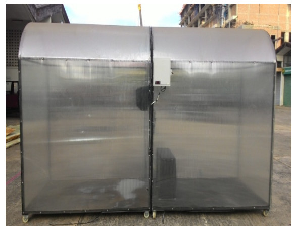
รูปที่ 1 ระบบอบแห้งแบบปั๊มความร้อนร่วมเรือนกระจก
