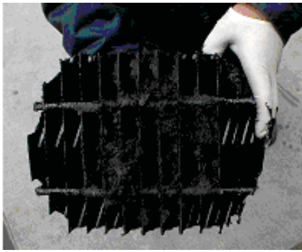
รูปที่ 2 การเกาะติดของน้ำมันดินในตัวกรองและเครื่องยนต์ [31]
