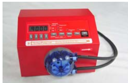
รูปที่ 3 อุปกรณ์จ่ายเชื้อเพลิงแบบปั๊มรีดยาง
