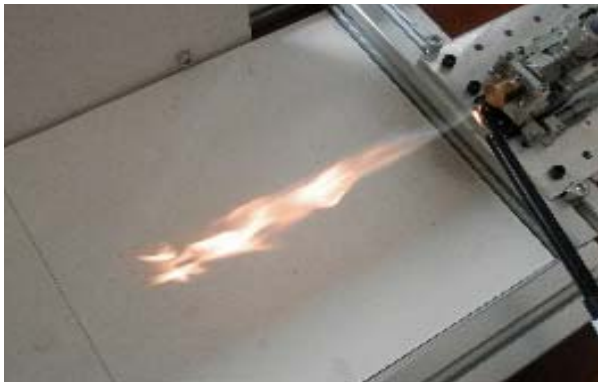
รูปที่ 14 เปลวไฟจากการทดสอบระบบเผาไหม้ ที่อัตราการไหลเชื้อเพลิง 8 mL/min และอากาศ 0.15 - 0.30 SCFM
