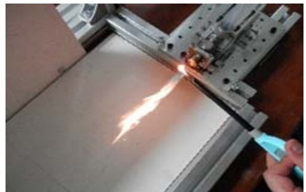
รูปที่ 12 เปลวไฟจากการทดสอบระบบเผาไหม้ ที่อัตราการไหลเชื้อเพลิง 4 mL/min และอากาศ 0.15 - 0.20 SCFM
