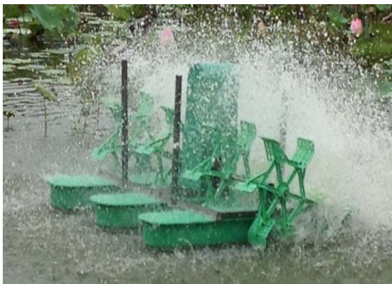
รูปที่ 2 เครื่องเติมอากาศบนผิวน้ำแบบสปีไบพัด
