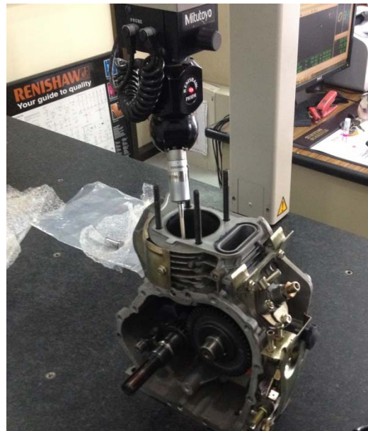
รูปที่ 3 การวัดขนาดปลอกสูบ
