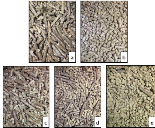
รูปที่ 1 แสดงลักษณะของเชื้อเพลิง 5 สัดส่วน ( a. ชีเลื่อยอัดเม็ด 100 เปอร์เซ็นต์ b. แกลบอัดเม็ด 100 เปอร์เซ็นต์ c. ชีเลื่อยอัดเม็ดผสมแกลบอัดเม็ด 75:25 เปอร์เซ็นต์ d. ชีเลื่อยอัดเม็ดผสมแกลบอัดเม็ด 50:50 เปอร์เซ็นต์ e. ชีเลื่อยอัดเม็ดผสมแกลบอัดเม็ด 25:75 เปอร์เซ็นต์ )
