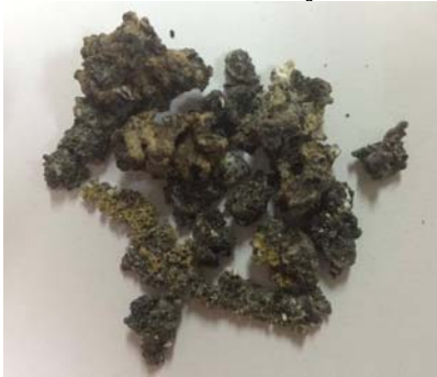
รูปที่ 13 แสดงลักษณะการรวมตัวเป็นก้อนของเถ้า
