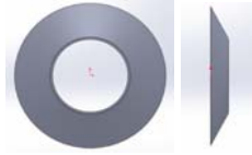
ข. เทอร์บิวเลเตอร์วงกรวย (Conical-ring turbulator, CORT)
