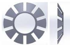
ค. เทอร์บิวเลเตอร์วงเฟือง (Gear-ring turbulator, GRT)
