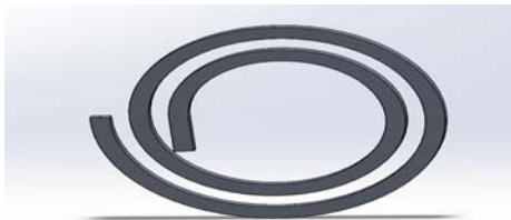
รูปที่ 7 ไมโครแชนแนลแบบโค้งที่มีรัศมีไม่คงที่ (Spiral)
