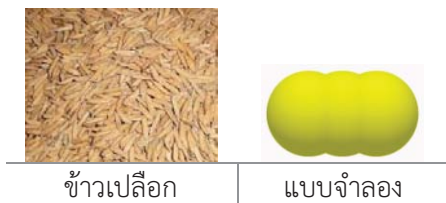
รูปที่ 1 ข้าวเปลือกและแบบจำลองของข้าวเปลือกที่ใช้ในวิธี DEM
