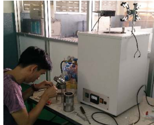
รูปที่ 4 การหาค่าความร้อนโดยเครื่อง bomb calorimeter
