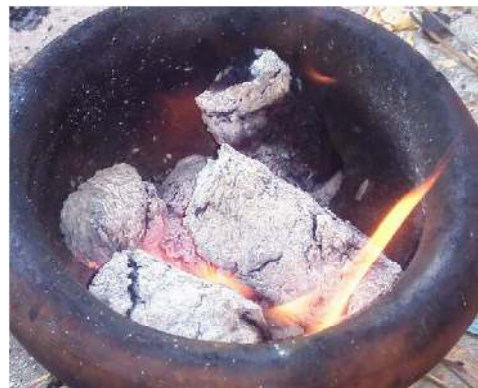
รูปที่ 8 ลักษณะการเผาไหม้ของแท่งเชื้อเพลิงจากขี้เลื่อยเผาผสมใบสดคานแห้งในการวิจัยครั้งนี้
