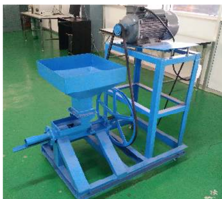
รูปที่ 2 ลักษณะเครื่องอัดเชื้อเพลิงแท่งชนิดเกลียวอัดที่สร้างขึ้น
