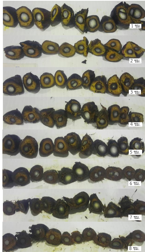
รูปที่ 6 แสดงลูกปาล์มที่ผ่าตรงกลางที่ผ่านการอบที่ระยะเวลาต่าง ๆ (กรณีรูระบายลมร้อน 24 รู)
