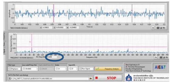
รูปที่ 6 สัญญาณจากเซ็นเซอร์ ADXL001 ที่ความเร็วในการอ่านสัญญาณ 4000 Hz
