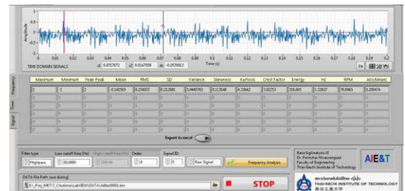
รูปที่ 8 ผลวิเคราะห์บนโดเมนเวลา ของสัญญาณจากเซ็นเซอร์ ADXL001 ที่ความเร็วในการอ่านสัญญาณ 8000 Hz
