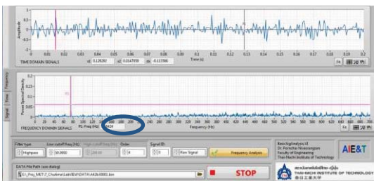
รูปที่ 5 สัญญาณจากเซ็นเซอร์ ADXL001 ที่ความเร็วในการอ่านสัญญาณ 2000 Hz
